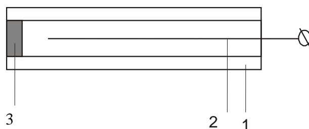
Р и с . 1. Схема ИСЭ с откликом на ион аскорбиновой кислоты 1– корпус из ПВХ; 2– токоотвод; 3– ионоселективная мембрана
